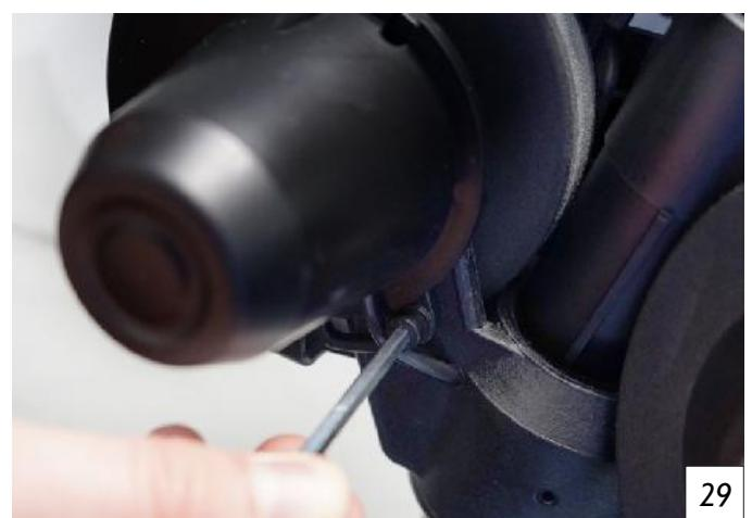
1. Postavite testni komad udaljenosti (crni valjak) između 3 kotača tako da su provaliju valjka u prazni nama između kotača. Ako je udaljenost kotača točna, sva 3 kotača trebala bi se malo okrenuti. Ako ne svi kotači dodiruju testni komad udaljenosti ili su kotači previše tjesni na ispitnom komadu, tada bi se distalans trebao podesiti (*picture 2 8*).
